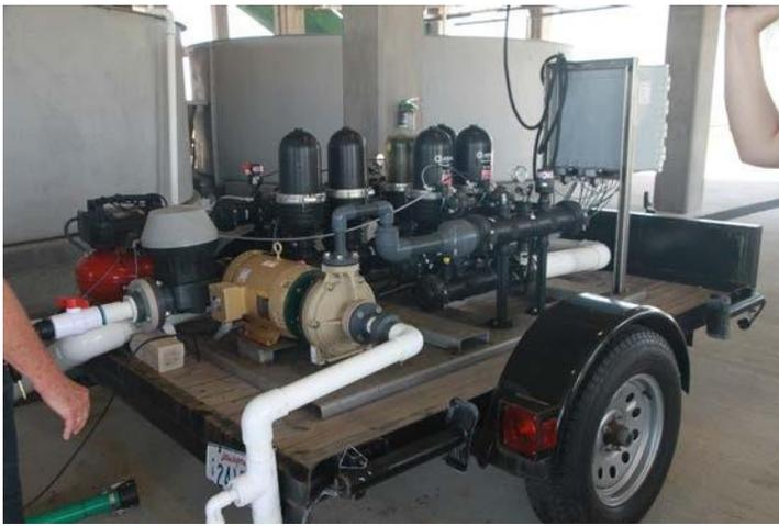
FIGURA 1. Equipo de filtración instalado en un remolque con desconexión rápida y accesorios de unión en el Criadero de Investigación de Ostras Louisiana Sea Grant en Grand Isle, Louisiana. Foto cortesía de la Extensión de Mariscos de la Universidad de Florida/IFAS
