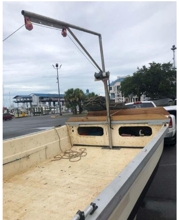
FIGURA 2. Pescante mecánico que se utiliza para levantar jaulas flotantes hundidas del fondo marino después de que haya pasado la tormenta. Foto cortesía de Jason Rider
